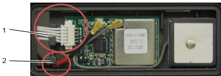
1 Kanalføring for USB-kabel 2 Antennekabelføring for GPS-gjennomgang
